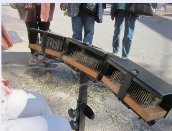
ARBEIDSTASJON FOR LINBEREDNING. LINHEKLING DEMONSTRERES OG VISER HVORDAN ET DEKSEL ER MONTERT OVER HEKLENE
